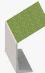
Verfüllung hinter der Mauer-scheibe mit ansteigendem Gelände; maximal  $30^\circ$
