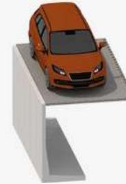
Verfüllung hinter der Mauer-scheibe, ebenes Gelände. Die gewonnene Fläche ist mit einem PKW befahrbar.
