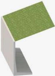
Verfüllung hinter der Mauer-scheibe mit anstei-gendem Gelände; maximal  $18^\circ$
