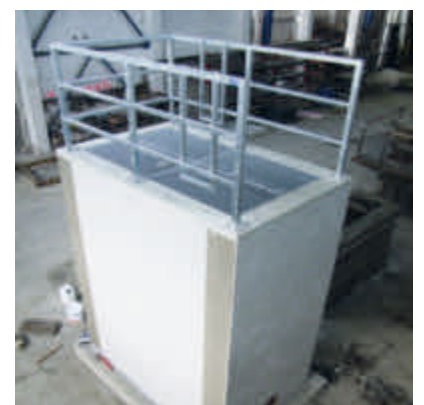
mit verzinktem, 3-seitigem Absturzgeländer
