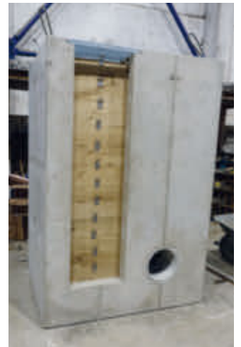
mit Staubohlen und Grundablasschieber
