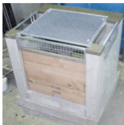
mit 3-seitigem Notüberlauf und Treibgutschutz durch Wellengitter
