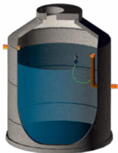
Retentionsschacht mit Retentionsdrossel
