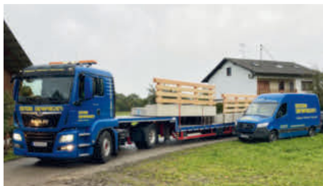
die 2-teilige Ausführung reduziert die Transportbreite
