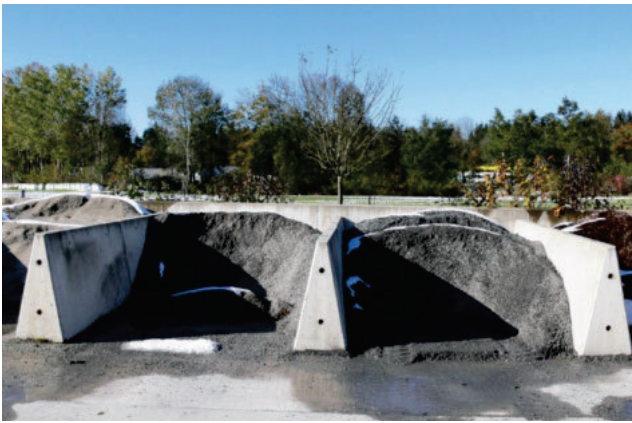
Schüttgutboxen 122 cm hoch zum Trennen von verschiedenen Gesteinskörnungen.
